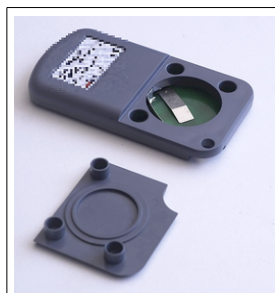
Elemcsere a kulcstartó méretű távvezérlőben
