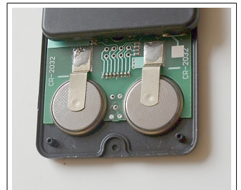
Elemcsere a hitelkártya méretű távvezérlőben
