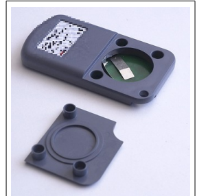
Elemcsere a kulcstartó méretű távvezérlőben
